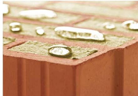
Die wasserabweisende Eigenschaft der Dämmstoffe macht das Mauerwerk gegen Feuchtigkeit unempfindlich. Eindringende Feuchtigkeit wird von dem Dämmstoff an den Ziegel weitergegeben und diffundiert durch die Kapillarwirkung des Ziegelmaterials nach außen.
