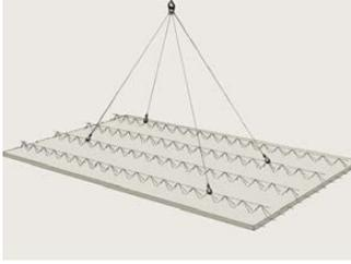
Die Lücking Plattendecke ist eine Deckenplatte mit Ortbetonergänzung nach EN 13747. Sie besteht aus großformatigen 5–7 cm dicken Fertigplatten, die durch Ortbeton ergänzt werden. Die Gitterträger bilden das für den Transport und die Montage aussteifende Element.
