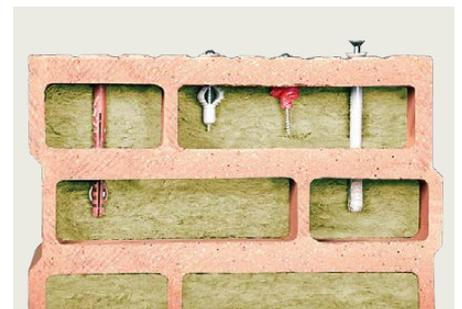
Der mind. 1,2 cm dicke Außenstege und die ebenso dicken Innenstege sorgen für hohe Auszugswerte der Dübel im Ziegel. Generell werden Löcher immer ohne Schlagwerk mit der Bohrmaschine gebohrt.
