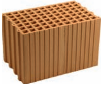
Erdbebensicheres Bauen und bei besonders hohen Anforderungen an die Tragfähigkeit, z. B. Innenwand Rohdichteklasse 0,9 f_k = 5,0 (SFK 12) bis 6,8 MN/m 2 (SFK 20) \lambda = 0,39 bis 0,58 W/mK (nach RDK) Wanddicken t = 17,5 / 20 / 24 / 30 cm
