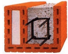
Ringbalken aus WU-Schale
