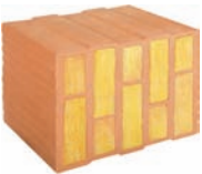
Füllung: Mineralfaserdämmplatten \lambda = 0,065 W/mK
