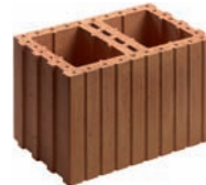
Schallschutz-Füllziegel für Wohnungs- / Haustrennwände zum Verfüllen mit fließfähigem Beton C12/15, Körnung 0-16 mm mit oder ohne Vertikalbewehrung R_{w,2}^{(2)} = 56,9 dB ( t = 17,5 cm) R_{w,2}^{(2)} = 60,8 dB ( t = 24 cm) R_{w,2}^{(2)} = 63,6 dB ( t = 30 cm)
