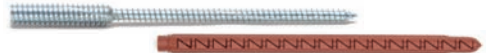
Beispiel eines typischen Befestigungssystems zur spannungsfreien Abstandsmontage von Fenstern in Hochlochziegeln bestehend aus Dübelhülse und Rahmenschraube
