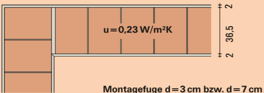
Ecktemperatur bei unterschiedlicher Ausbildung der Montagefuge hinsichtlich Fugenbreite und Füllmaterial:
