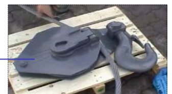
Umlenkrolle (wird an den Mobilkran angehängt)
