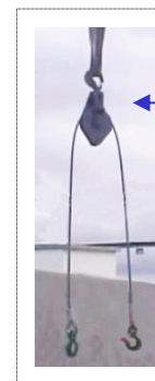
Umlenkrolle (wird an den Mobilkran angehängt)
