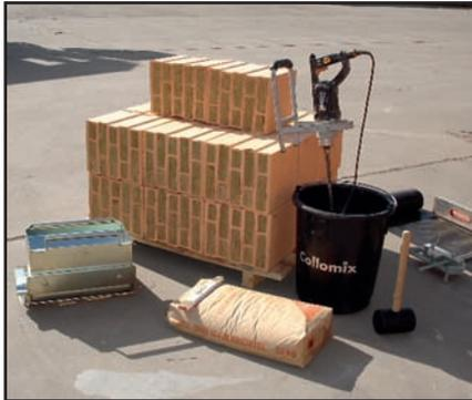
Auf der Baustelle benötigen Sie: VD-Mörtelwalze, 30 Liter-Mischeimer, Mörtelquirl mit Rührspindel, Justierboy, Alulatte, Leichtmörtel LM 21, Gummihammer
