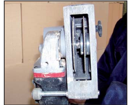
Spezial-Schlitzfräse mit 2 Diamant-Trennscheiben und verstellbarer Schnittbreite und -tiefe.
