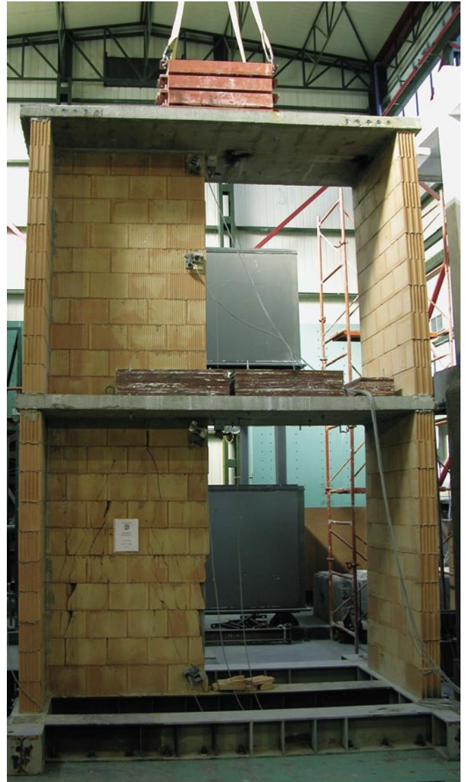
Bild 6: Prüfkörper mit Schubwänden aus Hochlochziegeln und Füllziegeln
